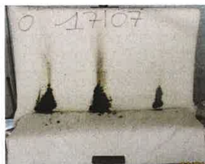
Il terzo innesco sulla provetta campiono 2
