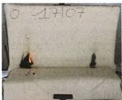
Il secondo innesco sulla provetta campiono 2
