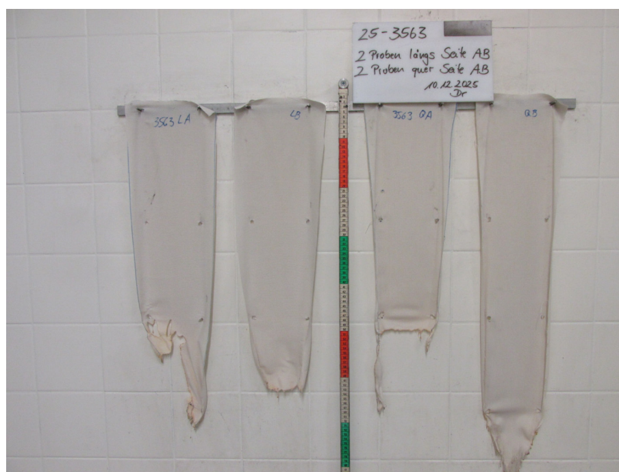
Bild 2: Aussehen der Proben nach dem Brandversuch
