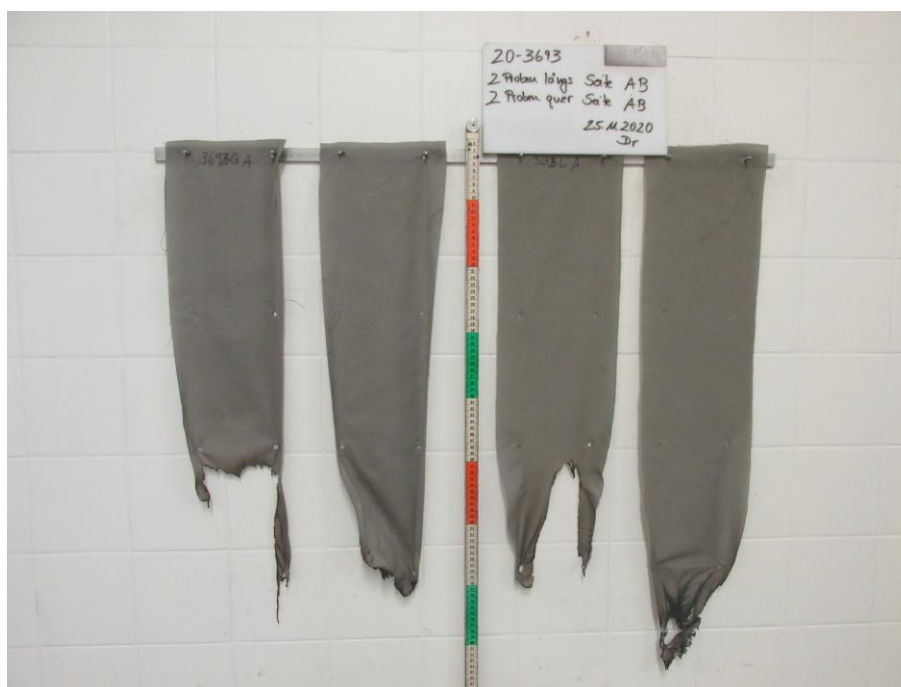
Bild 2: Aussehen der Proben nach dem Brandversuch
