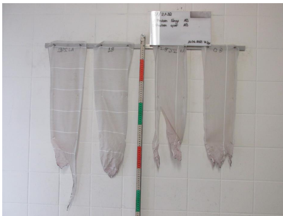
Bild 2: Aussehen der Proben nach dem Brandversuch
