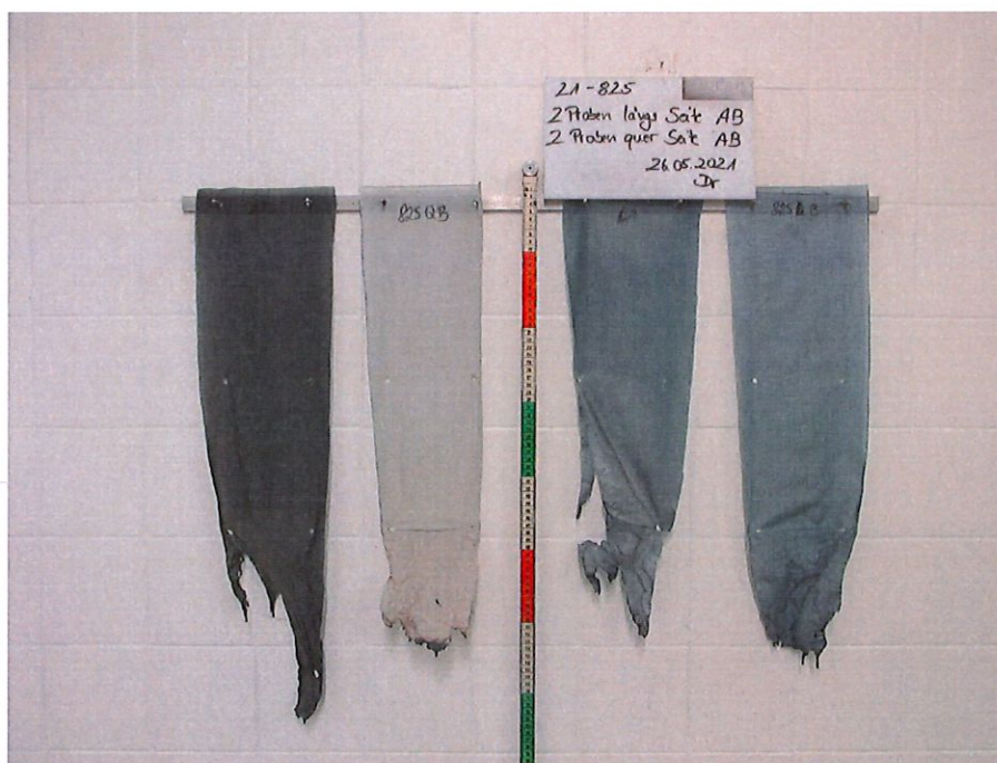
Bild 2: Aussehen der Proben nach dem Brandversuch
