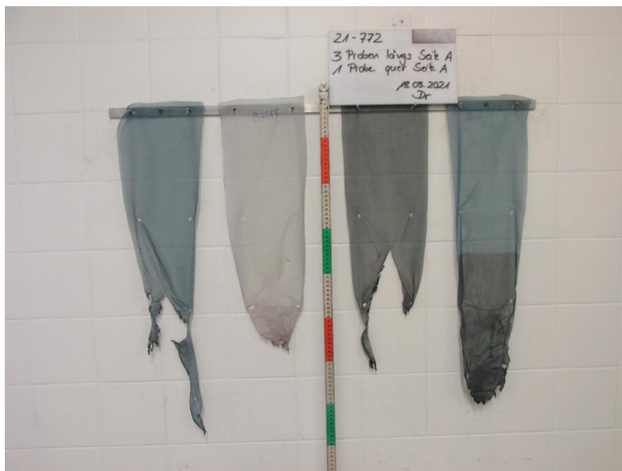
Bild 2: Aussehen der Proben nach dem Brandversuch
