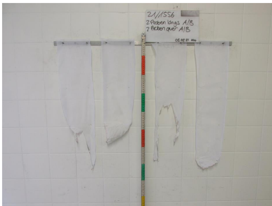
Bild 2: Aussehen der Proben nach dem Brandversuch
