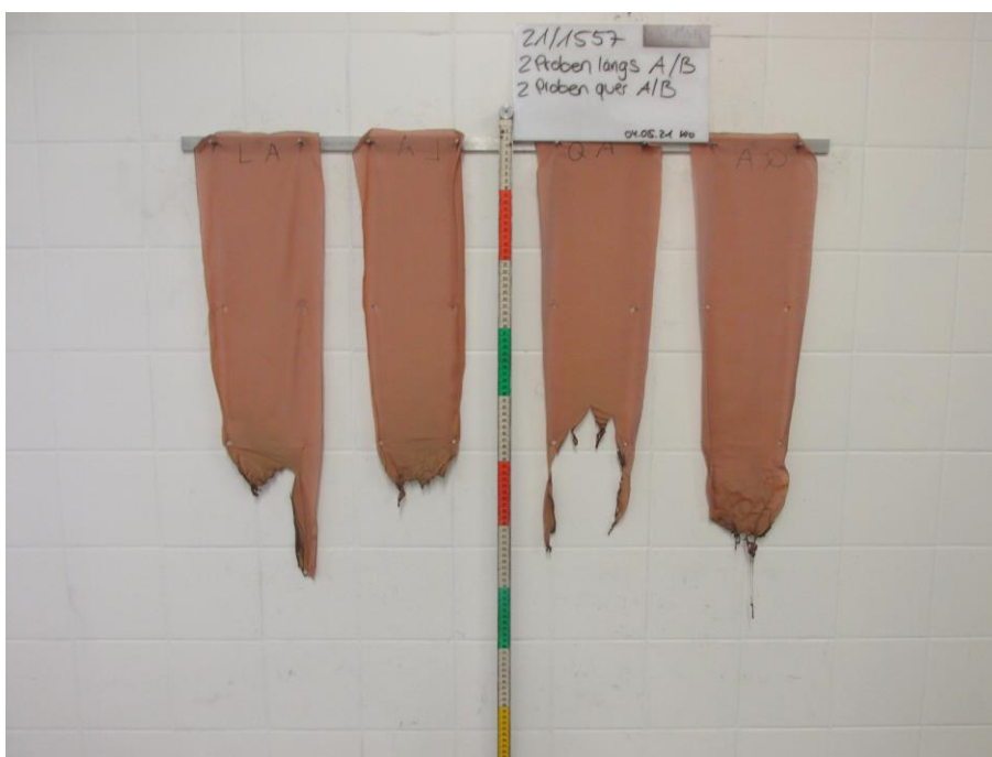
Bild 2: Aussehen der Proben nach dem Brandversuch
