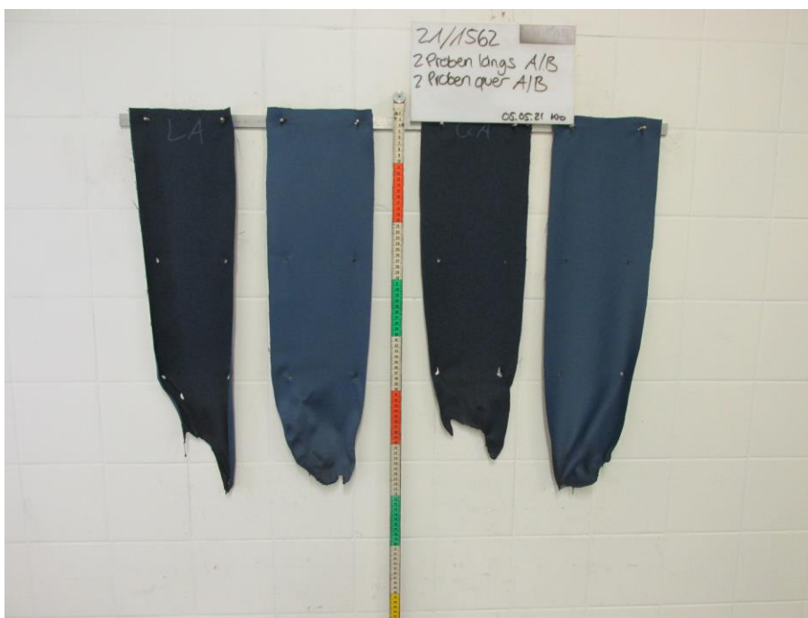
Bild 2: Aussehen der Proben nach dem Brandversuch
