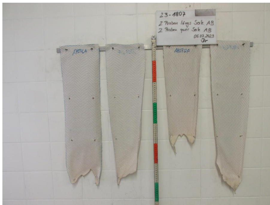
Bild 2: Aussehen der Proben nach dem Brandversuch
