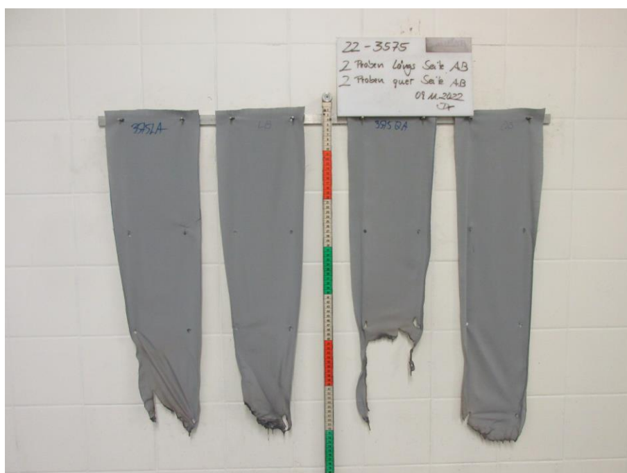
Bild 2: Aussehen der Proben nach dem Brandversuch
