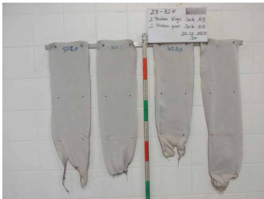
Bild 2: Aussehen der Proben nach dem Brandversuch
