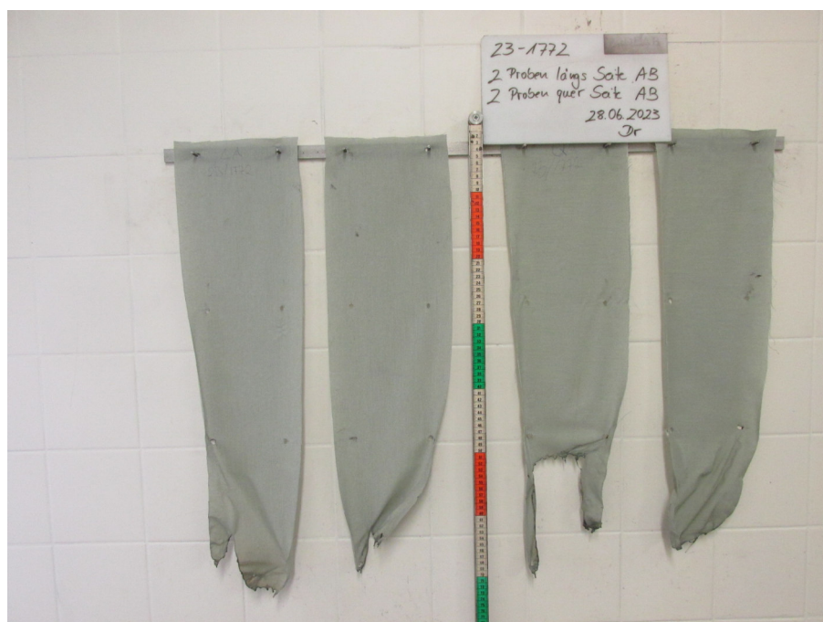
Bild 2: Aussehen der Proben nach dem Brandversuch
