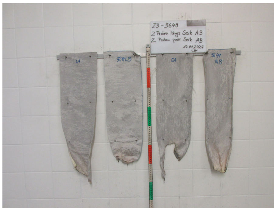
Bild 2: Aussehen der Proben nach dem Brandversuch
