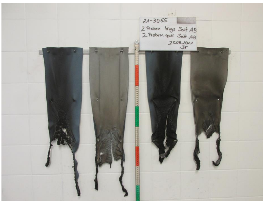
Bild 2: Aussehen der Proben nach dem Brandversuch
