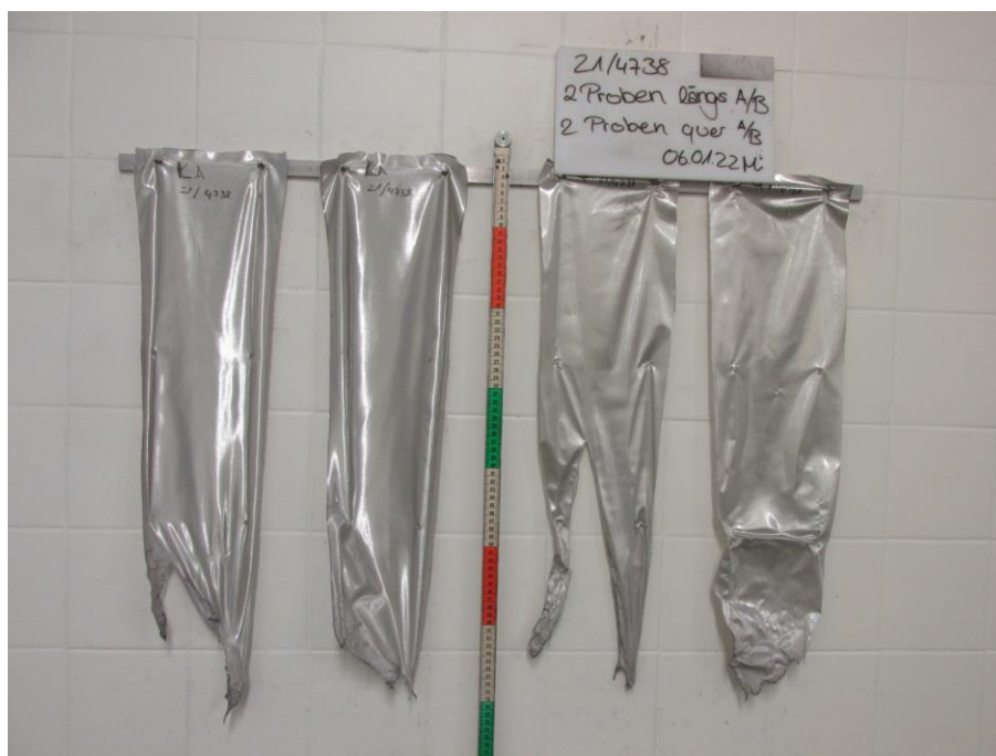
Bild 2: Aussehen der Proben nach dem Brandversuch
