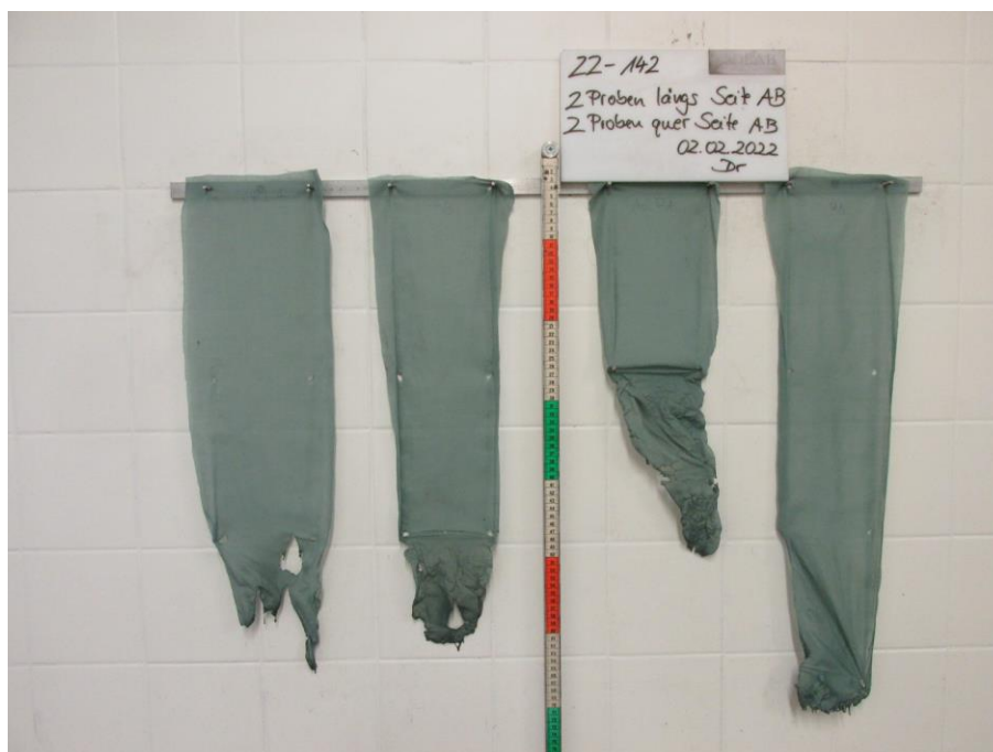
Bild 2: Aussehen der Proben nach dem Brandversuch
