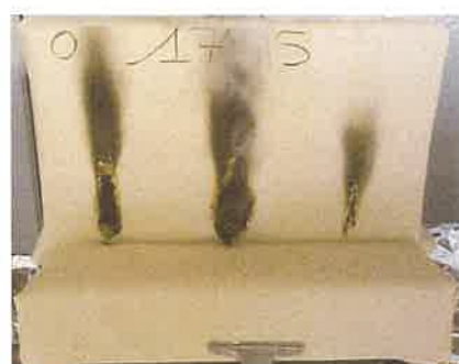
Il terzo innesco sulla provetta campiono 2
