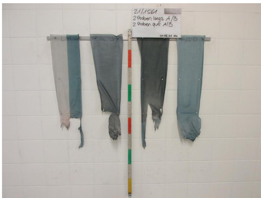
Bild 2: Aussehen der Proben nach dem Brandversuch
