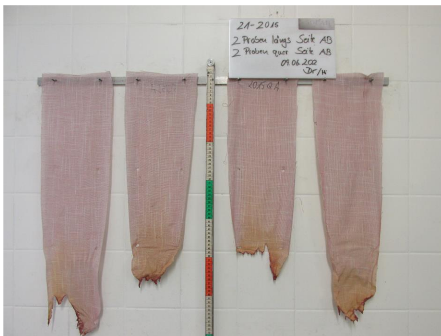
Bild 2: Aussehen der Proben nach dem Brandversuch
