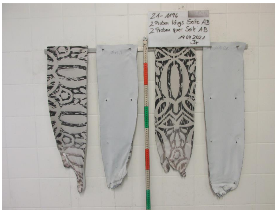
Bild 2: Aussehen der Proben nach dem Brandversuch
