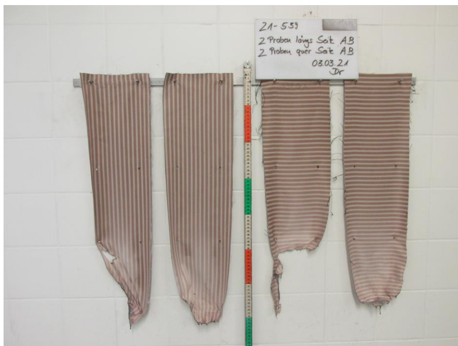
Bild 2: Aussehen der Proben nach dem Brandversuch
