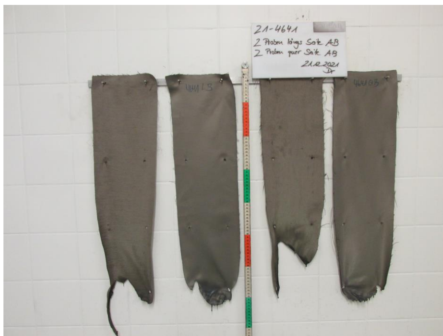
Bild 2: Aussehen der Proben nach dem Brandversuch
