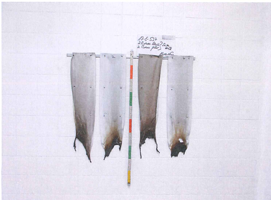
Bild 2: Aussehen der Proben nach dem Brandversuch
