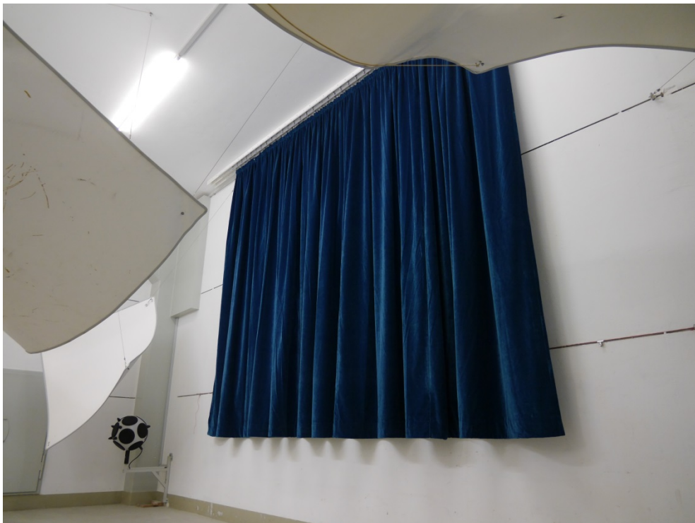
Abbildung B.2. Prüfanordnung im Hallraum (Schrägensicht).
