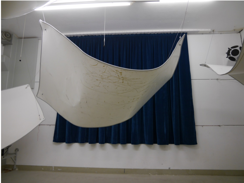
Abbildung B.1. Prüfanordnung im Hallraum (Frontalansicht).
