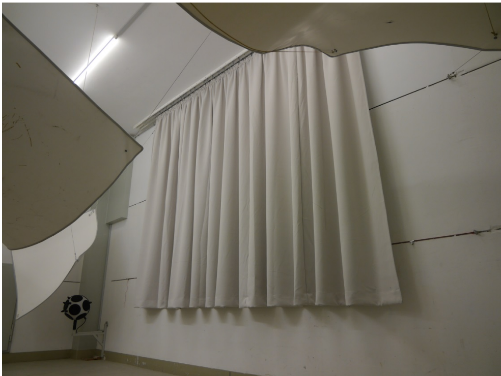
Abbildung B.2. Prüfanordnung im Hallraum (Schrägansicht).
