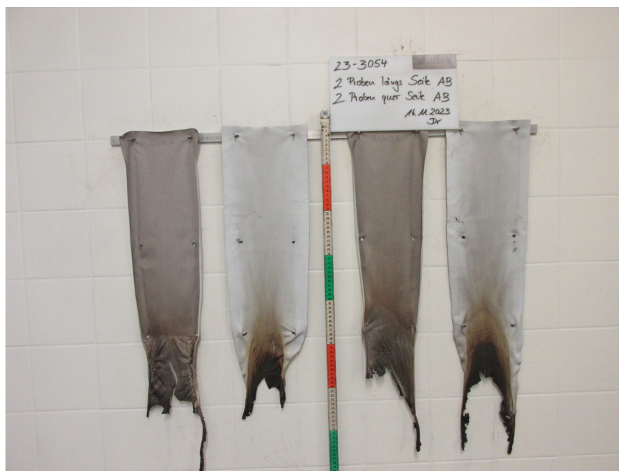
Bild 2: Aussehen der Proben nach dem Brandversuch
