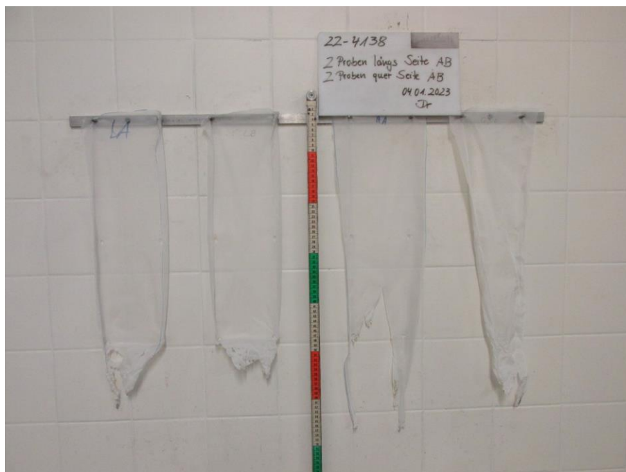
Bild 2: Aussehen der Proben nach dem Brandversuch
