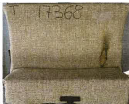
Il primo innesco sulla provetta campione 1
