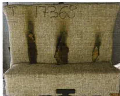
Il terzo innesco sulla provetta campione 1
