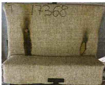
Il secondo innesco sulla provetta campione 1
