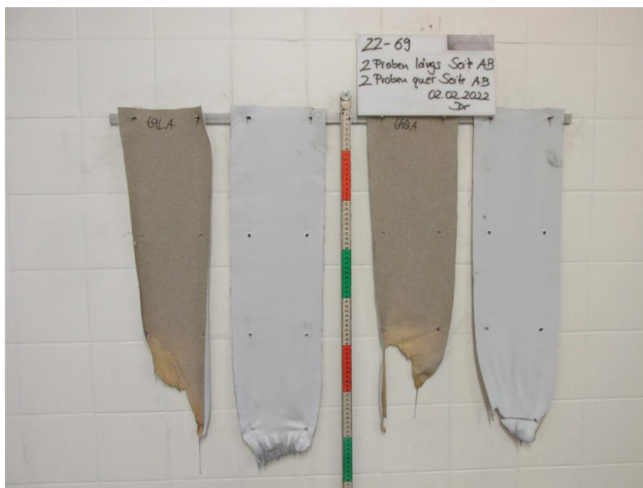
Bild 2: Aussehen der Proben nach dem Brandversuch
