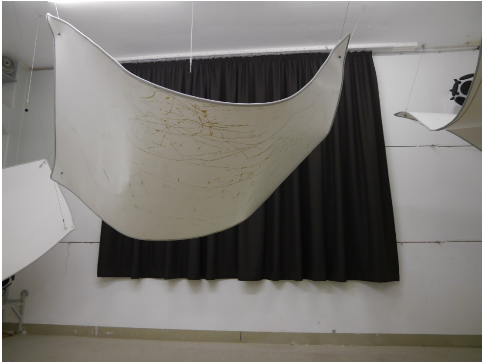
Abbildung B.1. Prüfanordnung im Hallraum (Frontalansicht).
