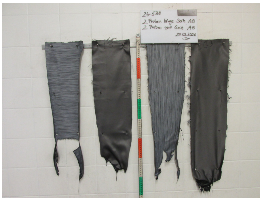
Bild 2: Aussehen der Proben nach dem Brandversuch
