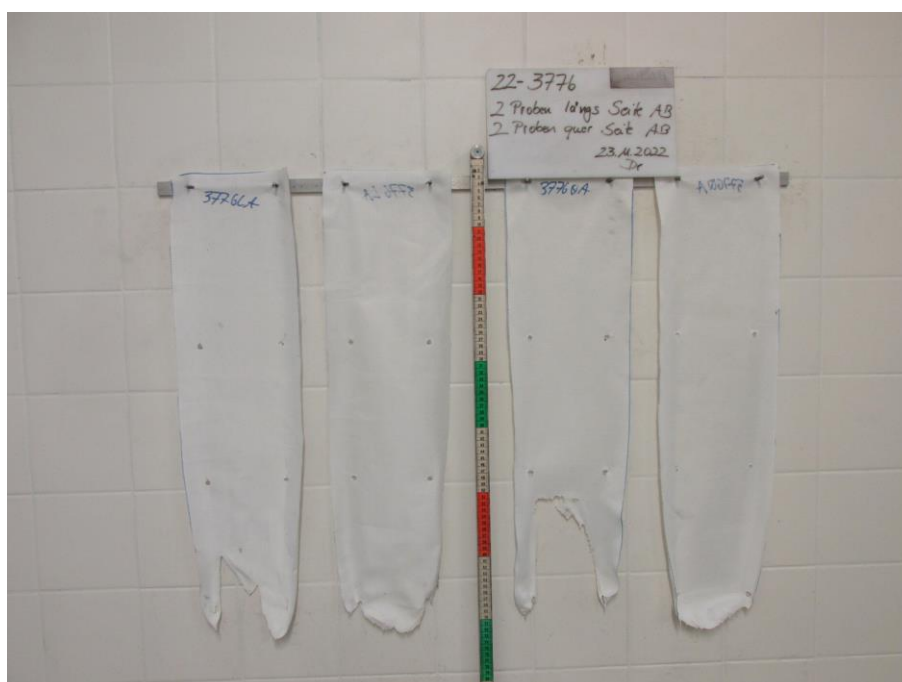
Bild 2: Aussehen der Proben nach dem Brandversuch
