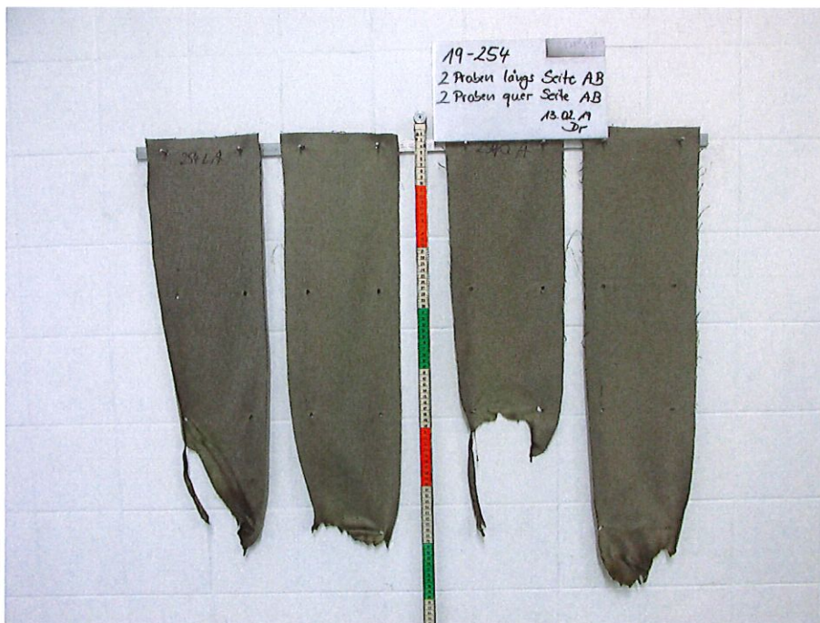
Bild 2: Aussehen der Proben nach dem Brandversuch
