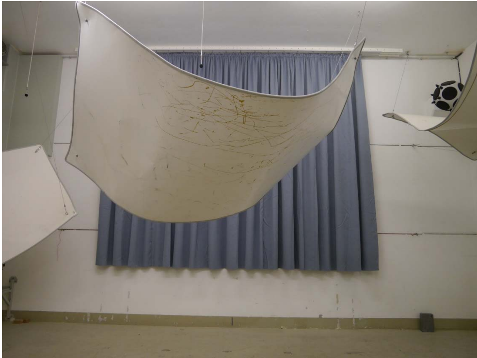
Abbildung B.1. Prüfanordnung im Hallraum (Frontalansicht).
