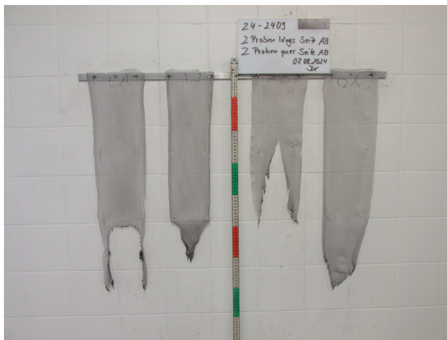
Bild 2: Aussehen der Proben nach dem Brandversuch
