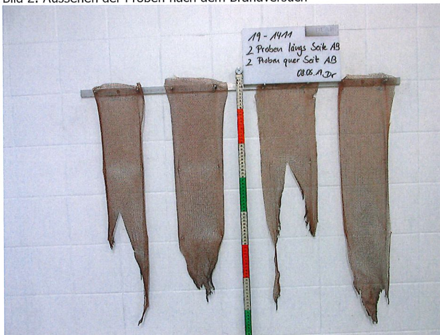
Bild 2: Aussehen der Proben nach dem Brandversuch
