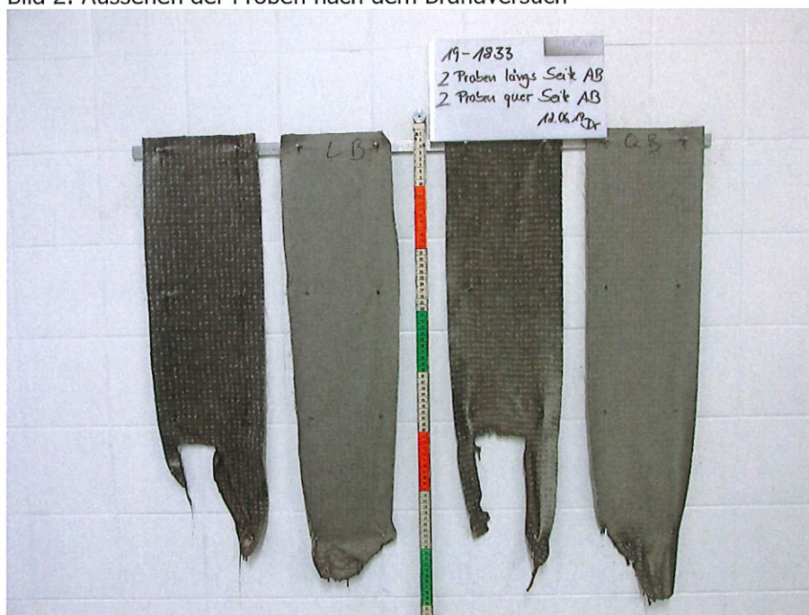
Bild 2: Aussehen der Proben nach dem Brandversuch
