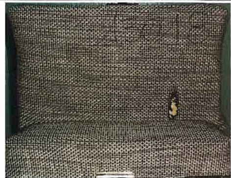
Campione 2 Il primo innesco sulla provetta
