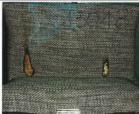
Campione 2 Il secondo innesco sulla provetta
