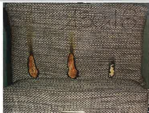
Campione 2 Il terzo innesco sulla provetta
