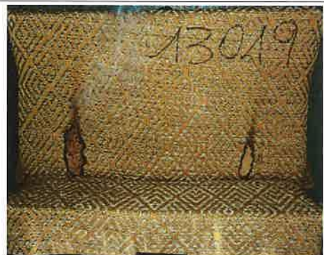
Campione 1 Il secondo innesco sulla provetta
