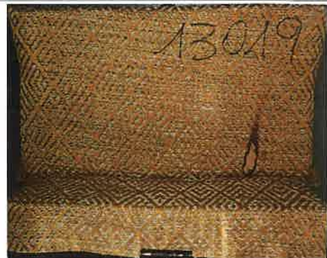
Campione 1 Il primo innesco sulla provetta
