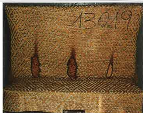
Campione 1 Il terzo innesco sulla provetta
