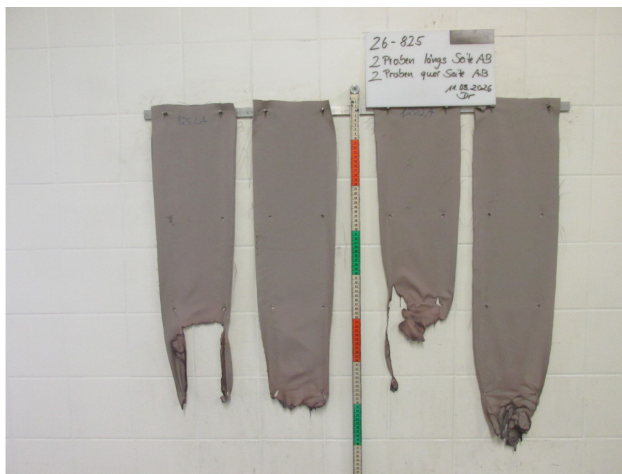
Bild 2: Aussehen der Proben nach dem Brandversuch
