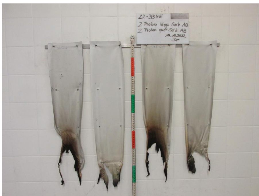
Bild 2: Aussehen der Proben nach dem Brandversuch
