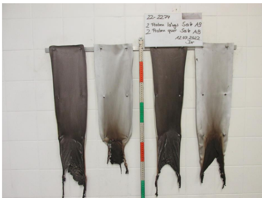
Bild 2: Aussehen der Proben nach dem Brandversuch
