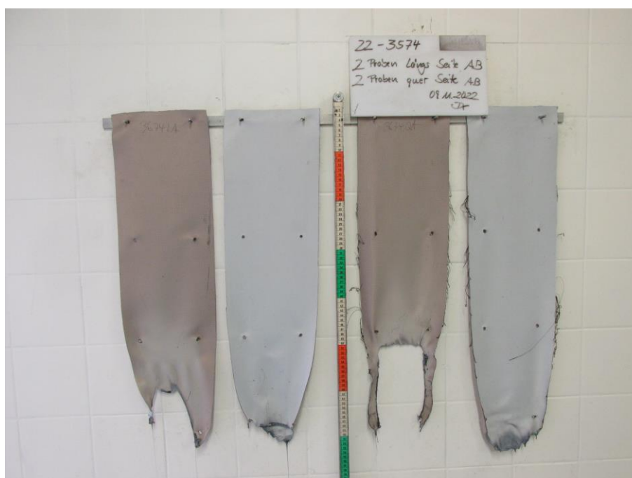
Bild 2: Aussehen der Proben nach dem Brandversuch
