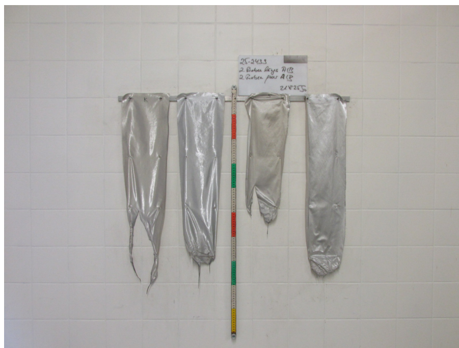
Bild 2: Aussehen der Proben nach dem Brandversuch
