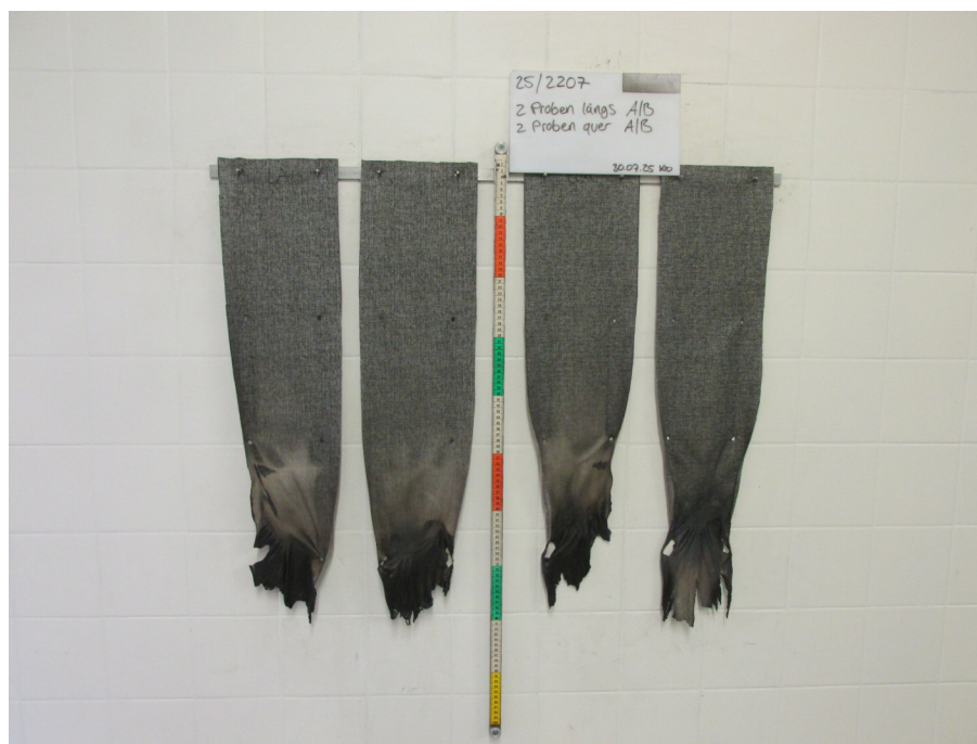
Bild 2: Aussehen der Proben nach dem Brandversuch
